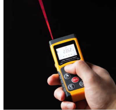
Resim 3.27 LASER ile uzunluk ölçümü
