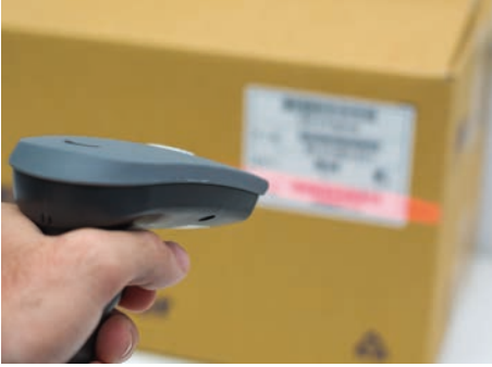
Resim 3.30 LASER ile barkod okuma
